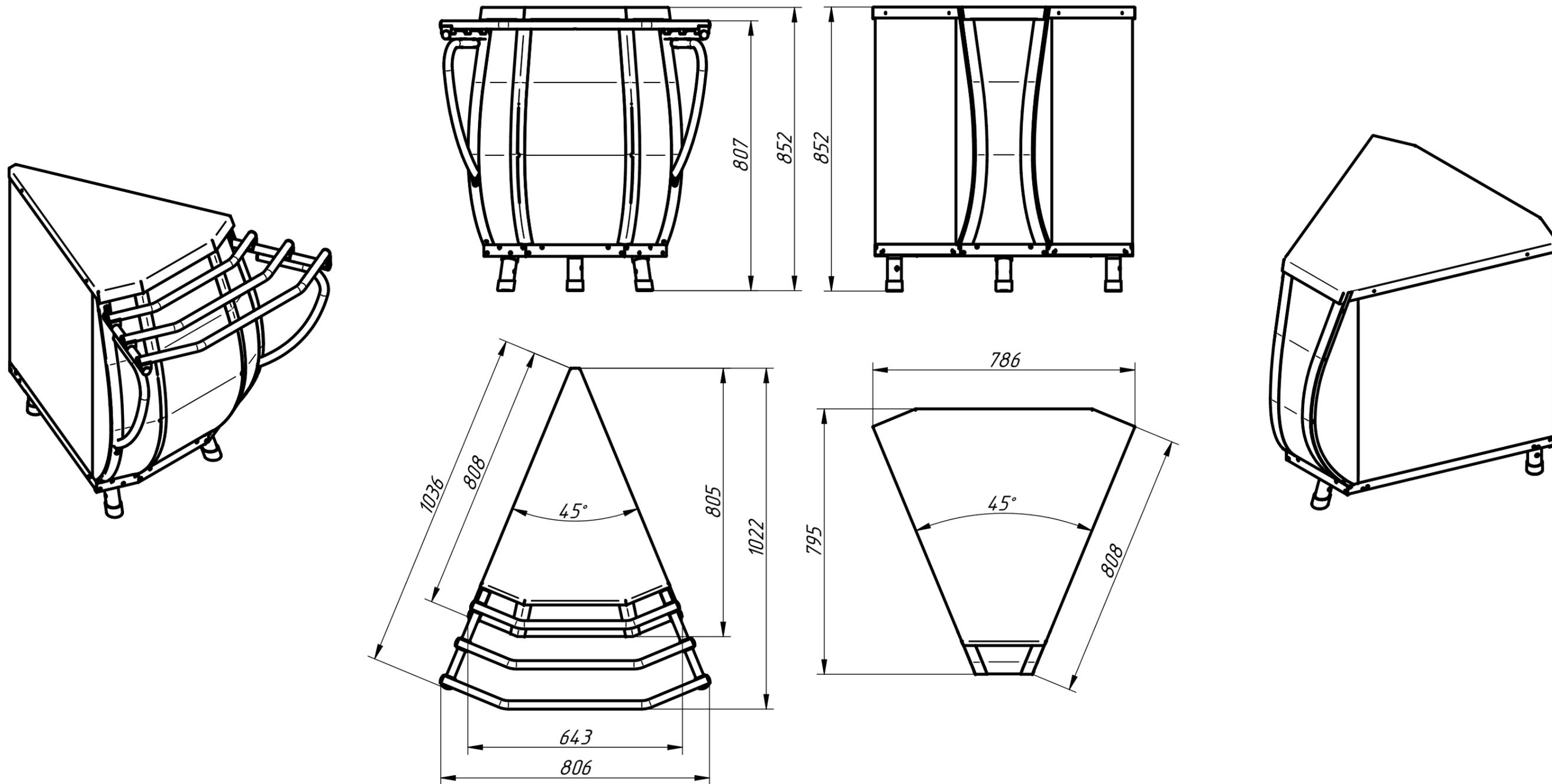
Модуль поворотный внешний (внутренний) служит в качестве нейтрального стола, одновременно позволяя поворачивать технологические линии раздачи под углом 45 градусов, не разрывая линию направляющих для подносов.
