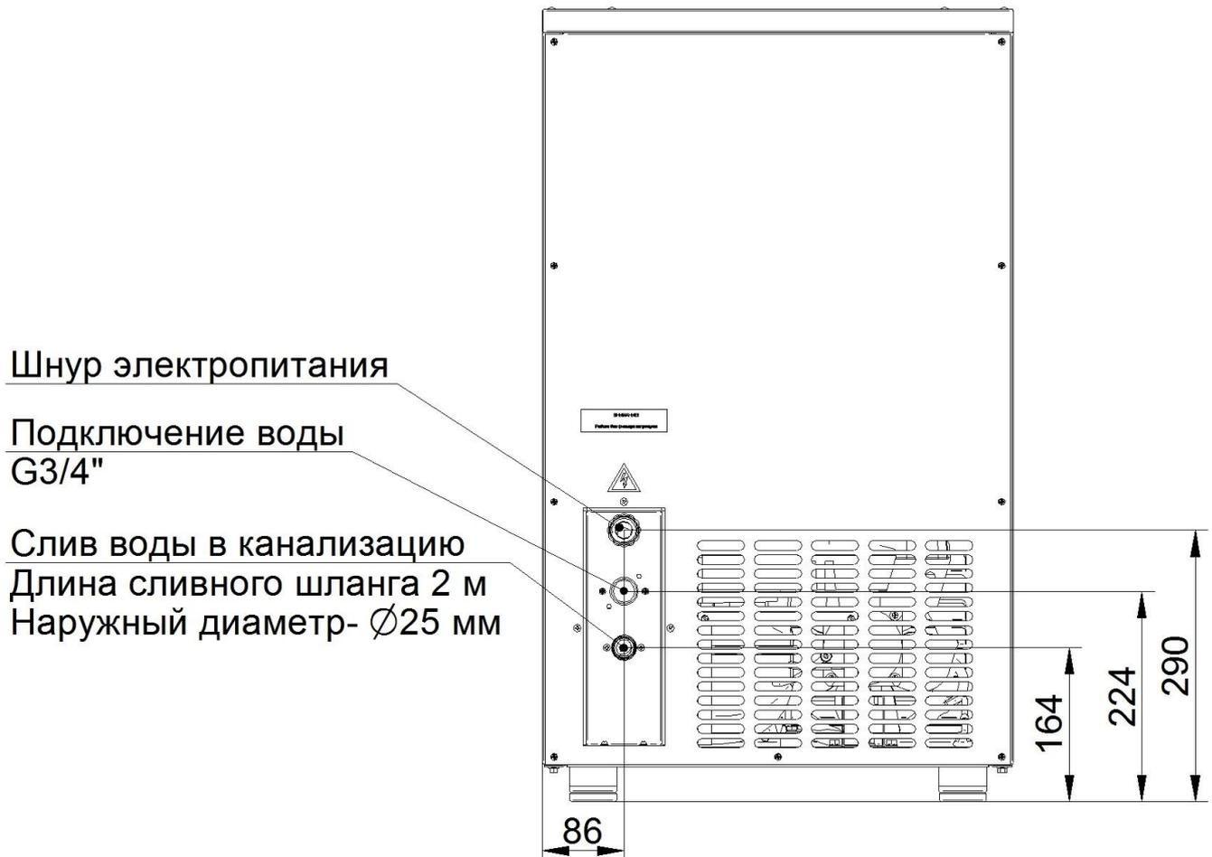
Рис. 4 Схема подключения льдогенератора
