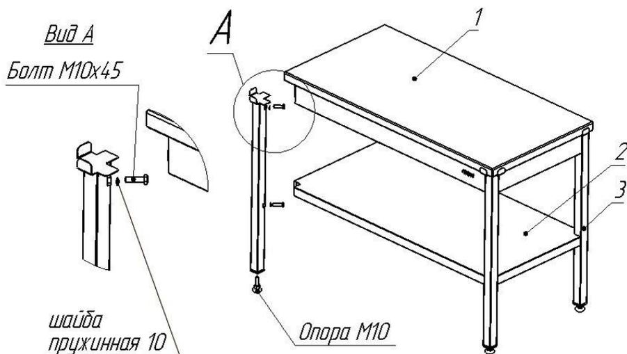
2.5. Произвести окончательную затяжку всех болтовых соединений.
