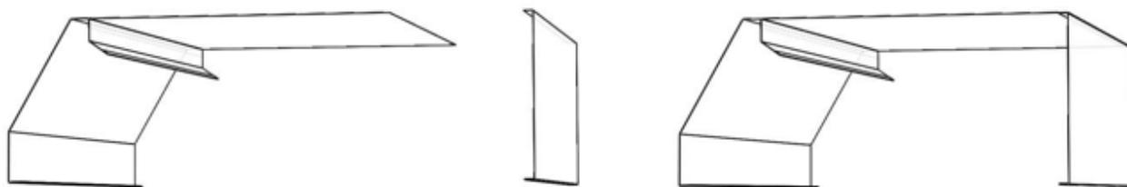
3) Закрепить боковины с передней панелью, крышей и задней стенкой при помощи болтов М5.
