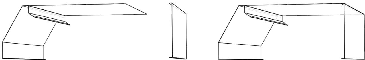
3)Закрепить боковины с передней стенкой, крышей и задней стенкой при помощи болтов M5.
