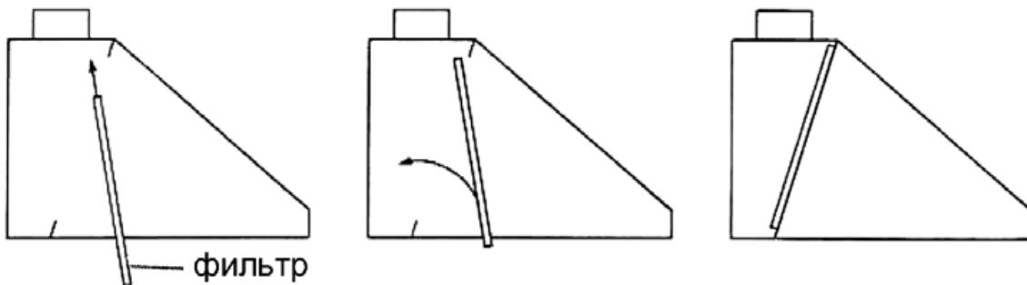
При интенсивном использовании рекомендуется промывать зонт 1 раз в 2 месяца, при малой интенсивности 1 раз в 6 месяцев щёткой-ершиком под тёплой проточной водой (предварительно отключив от электросети – в моделях, оснащенных подсветкой и вентилятором).
