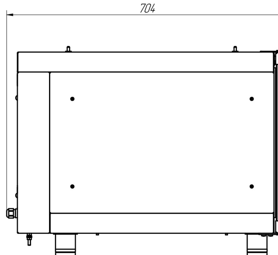
Шкаф расстоечный тепловой предназначен для расстойки мелкоштучных хлебобулочных и кондитерских изделий на предприятиях общественного питания. Основной режим работы – расстойка продукта при температуре 45° С. Шкаф может использоваться на предприятиях общественного питания как самостоятельно, так и в составе технологической линии. Камера и наружные поверхности выполнены из высококачественной нержавеющей стали. Имеется лоток для сбора конденсата.
