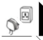
Электропитание аппарата осуществляется от сети переменного тока напряжением 220 В, частотой 50 Гц. Питание однофазное от отдельной трёхконтактной розетки.
