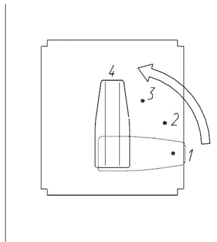
Если дым начал выходить из двери печи во время приготовления большого количества продуктов, верхний регулятор воздуха нужно открыть в достаточной мере, чтобы устранить и вывести дым.
