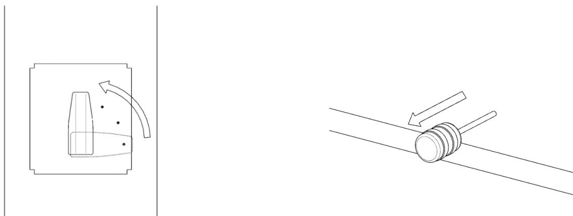
**ПРИМЕЧАНИЕ!!!** Отверстие для поступления воздуха в модели BCJ – 25 и BCJ – 25 Н управляется (контролируется) при помощи открытия и закрытия ящичка для сбора пепла (золы) в нижней части печи. Чтобы открыть воздушную заслонку, вытащите ящик, чтобы он оказался открытый на 2-3 см.
